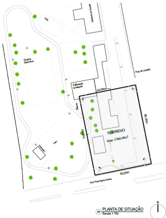
**2.4.** A edificação será implantada em um terreno com área de **2.580,00 m<sup>2</sup>** e contará com área construída total de **703,97 m<sup>2</sup>**, correspondente a uma edificação térrea, contemplando os seguintes setores principais:
